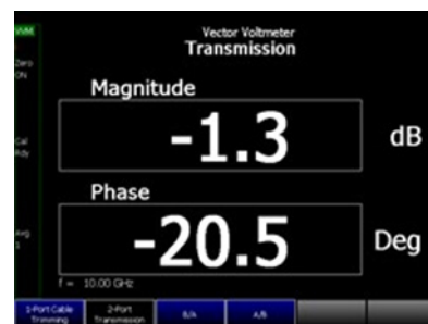
Балансировка кабелей с помощью векторного вольтметра
